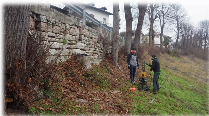
Esecuzione Prova Penetrometrica Dinamica Media (DPM)
